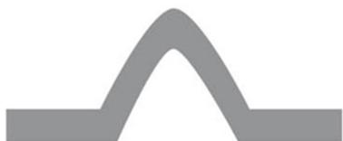
dvostruka "v" ojačanja za otpornost na savijanje
